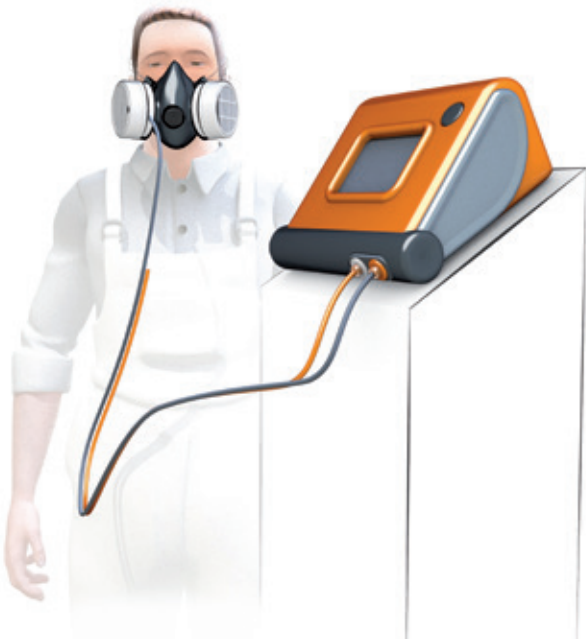
(Essai d'ajustement quantitatif
